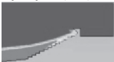
Hình 2.13: Sóng tác dụng lên tường hắt sóng
