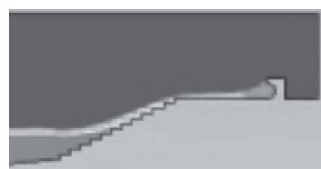
Hình 2.14: Sóng tác dụng lên tường hắt sóng kết hợp thêm giảm sóng
