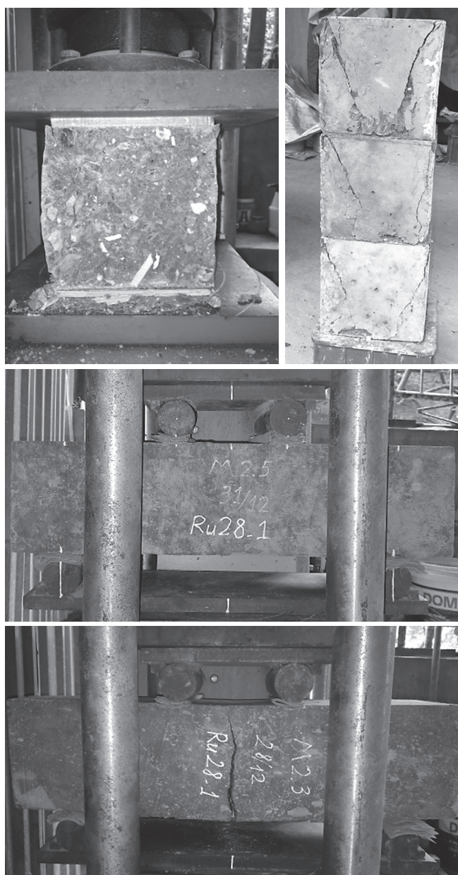
Hình 2.3: Tiến trình thí nghiệm và dạng phá hoại mẫu
