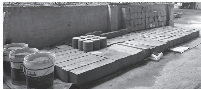
Hình 2.2: Phối trộn vật liệu và chế bị mẫu thí nghiệm
