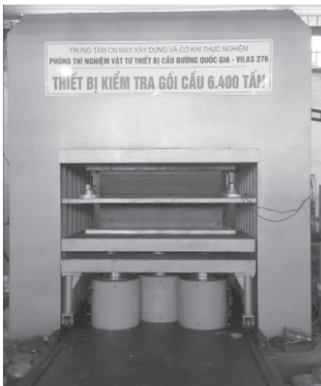
Thiết bị kiểm tra gối cầu tải trọng 6.400 tấn
