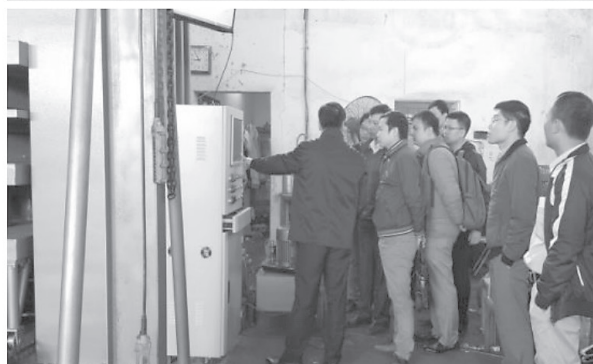
Thiết bị kiểm tra gối cầu tải trọng 6.400 tấn
