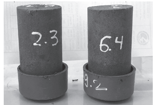
b) - Mẫu chuẩn bị làm thí nghiệm nén tại tuổi 28 ngày
