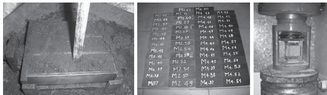
Hình 2.2: Mẫu vữa geopolymer tro bay và thí nghiệm xác định cường độ nén
