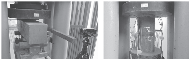
Thí nghiệm xác định cường độ chịu kéo khi uốn
