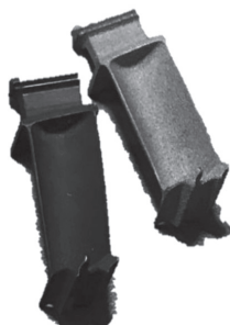
Hình 3.1: Chi tiết cánh tua-bin động cơ TV3-117
