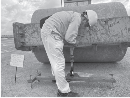
Hình 3.2: Thí nghiệm xác định CBR hiện trường của lớp đất sỏi dõi tại sân bay Phan Thiế
