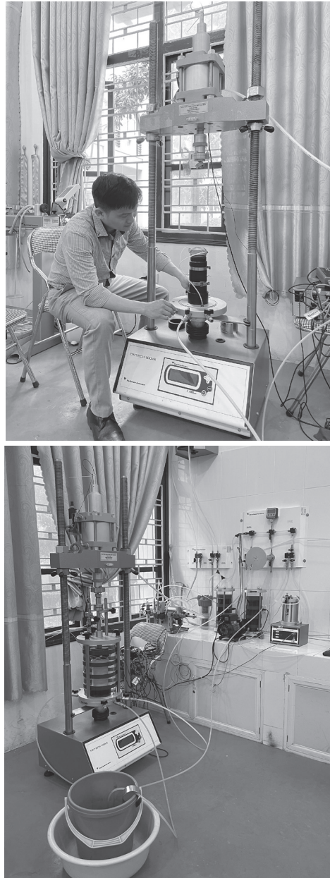
Hình 3.1: Thí nghiệm xác định mô-đun đàn hồi tĩnh bằng thiết bị ba trục trong phòng
