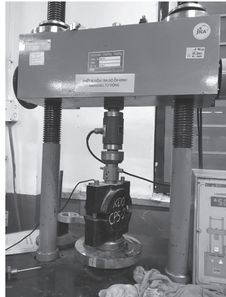
Hình 3.3: Thí nghiệm độ ổn định Marshall
