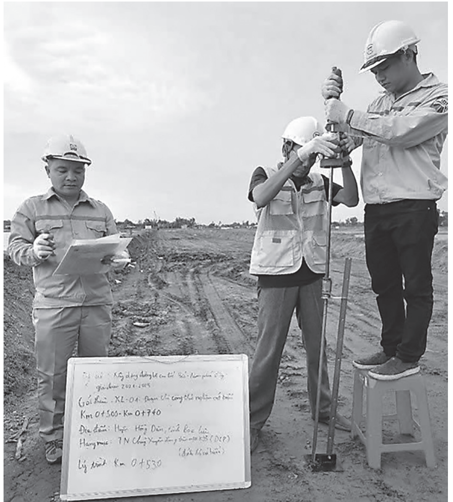
Đội ngũ kỹ sư của Viện Khoa học và Công nghệ GTVT thử nghiệm cát biển đắp nền đường tại hiện trường
