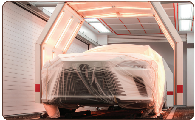
Phòng sơn sấy robot tự động IRT Power Cure tại Lexus Thăng Long. Ảnh: Lexus Việt Nam
