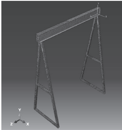
Hình 3.2: Chia lưới khung cổng trục bằng phần mềm Abaqus
