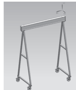
Hình 3.1: Cổng trục đẩy tay tải trọng 1 tấn
