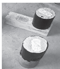
Hình 2.5: Mẫu thử sau khi cắt và được chống thấm mặt bên
