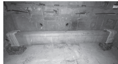
a) - Dầm thí nghiệm trong lò nung
