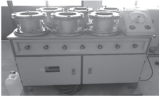
Hình 2.2: Thiết bị xác định độ chống thấm nước của bê tông (HS - 40)
