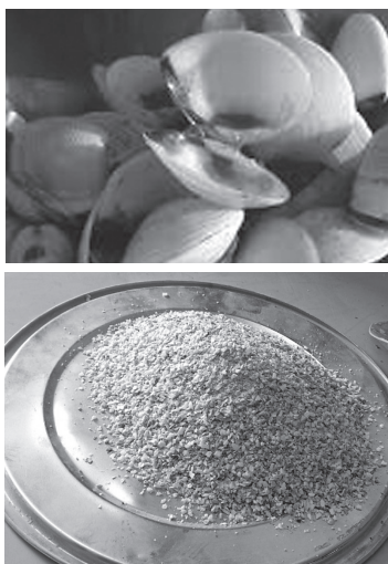
Hình 2.1: Vỏ nghêu Bến Tre được nghiền thành cỡ hạt từ 1 mm đến 4,75 mm
