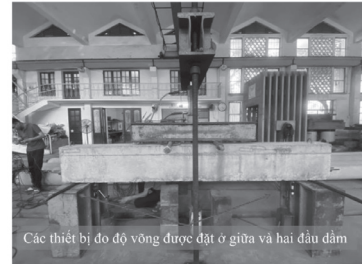
a) - Thí nghiệm uốn dầm đối chứng (dầm 04)
