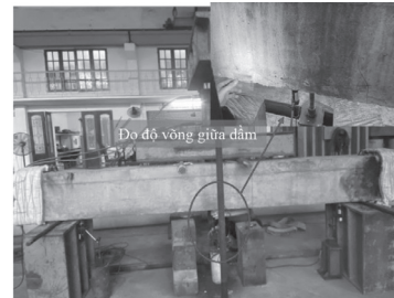
b) - Thí nghiệm uốn dầm cháy (dầm 03)
