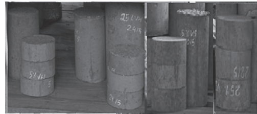
Hình 2.2: Mẫu bê tông đúc nguyên kích thước (100x 200)mm và các mẫu thấm clorua được cắt ra có kích thước (50x100)mm
