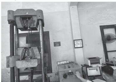
b) - Thí nghiệm kéo cáp DUL sau cháy
