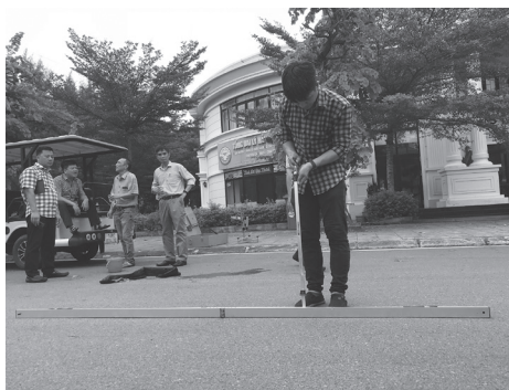
a) - Đo độ bằng phẳng bằng thước 3 m
