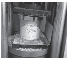
Hình 2.4: Nén trước các mẫu thử trước các cấp tải trọng khác nhau
