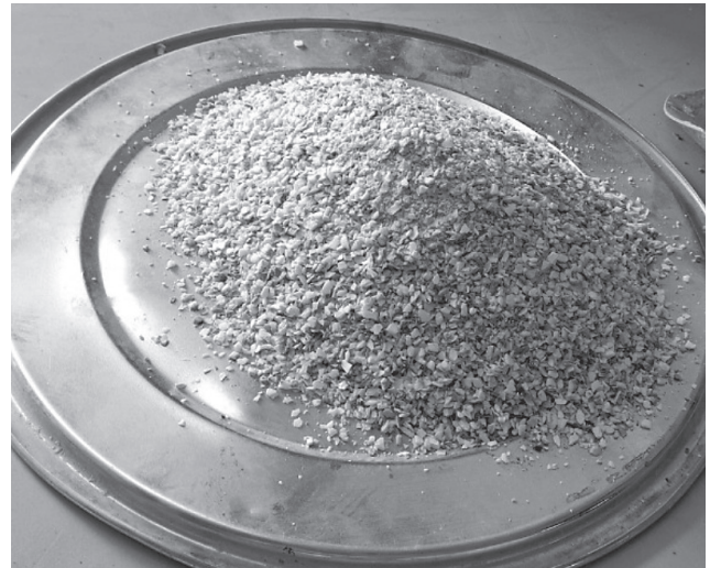
b) - Vỏ ngao nghiền có cỡ hạt từ 1mm đến 4,75 mm
