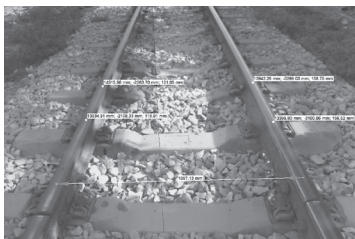
Hình 3.1: Thiết bị quét 3D và trích xuất dữ liệu từ Point Cloud
