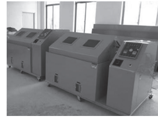
Hình 2.2: Thiết bị sử dụng trong thí nghiệm phun muối [8]
