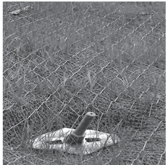
Hình 4.1: Các thí nghiệm đánh giá khả năng chống xói mòn của các lưới khác nhau
