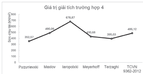
Hình 4.2: Biểu đồ giá trị giải tích sức chịu tải nền của 4 trường hợp [2], [7], [8], [9], [10]
