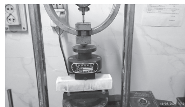
b) - Thí nghiệm cường độ kéo uốn
