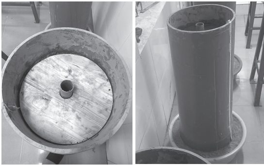
Hình 2.1: Thùng thí nghiệm mô hình vật lý trụ đơn
