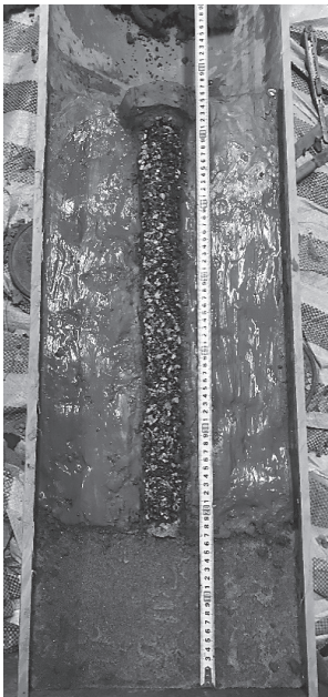
Hình 2.4: Mẫu thí nghiệm trụ đơn vật liệu hạt rời ở trạng thái phá hoại
