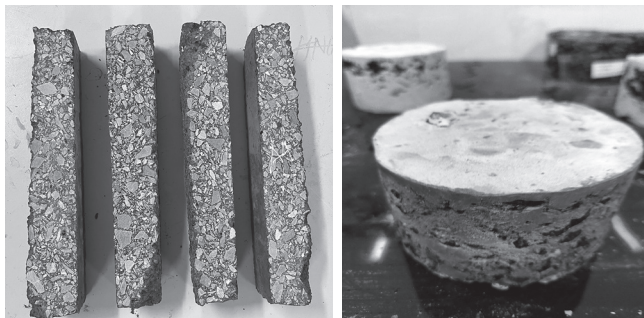
a) - Mẫu thí nghiệm cường độ chịu kéo khi uốn b) - Mẫu thí nghiệm cường độ kéo gián tiếp Hình 3.3: Chuẩn bị mẫu CA bán mềm
