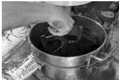
Hình 2. Thiết bị trộn cưỡng bức 4 cấp độ tại phòng thí nghiệm
