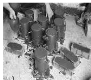
(b) Đổ bê tông vào mẫu trụ.
