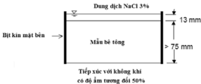
Hình 1. Sơ đồ thí nghiệm theo AASHTO T259 (salt ponding)
