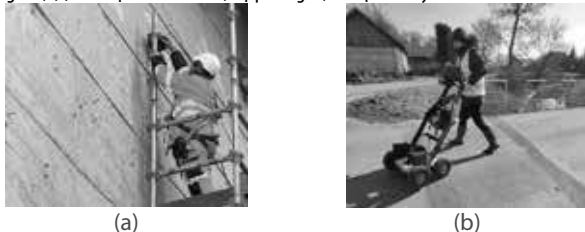
Hình 3. Thu thập dữ liệu GPR: (a) Trên bề mặt thẳng đứng bằng Anten tần số cao, (b) Quét mặt cầu bằng Anten tần số trung bình
