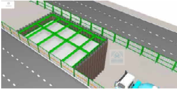
Thi công bệ trụ, đảm bảo giao thông.
