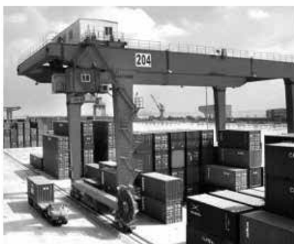
Cầu bãi loại bánh ray (RMG)
