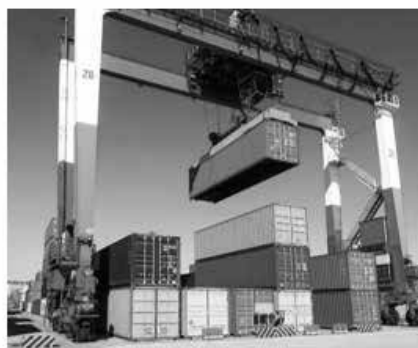
Cầu bãi loại bánh lốp (RTG)
