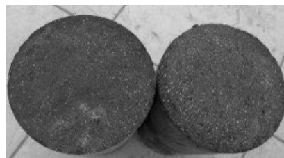
Hình 4. Mài phẳng mẫu trụ UHPC
