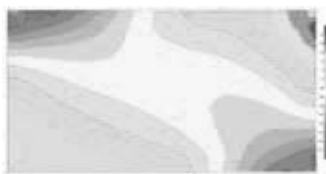
Hình 23. Ứng suất nén chính trong tường xây chèn (kN/m 2 )
