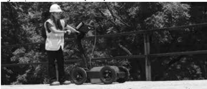
Hình 5. (a) Thu thập dữ liệu trên bản mặt cầu bằng thiết bị GPR. (b) Dữ liệu GPR mẫu được ghi lại trên lớp phủ mặt cầu [3][8][9]
