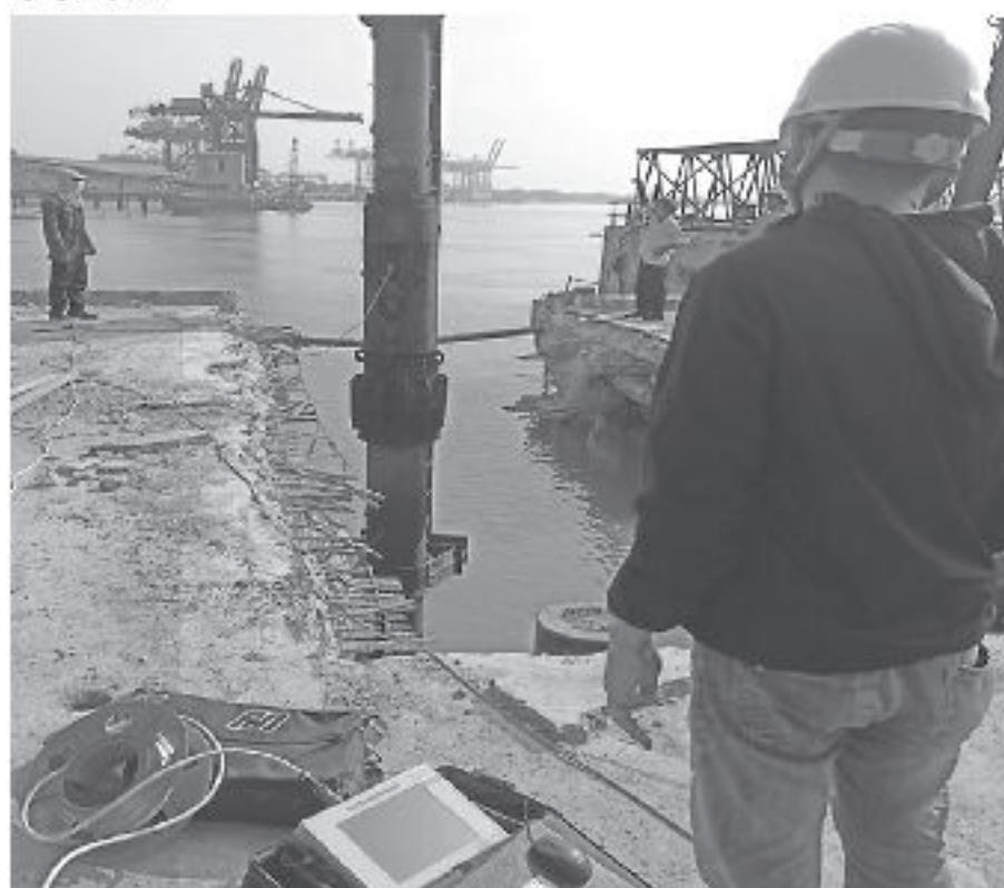
Hình 2.1: Thiết bị kiểm tra sức chịu tải của cọc theo phương pháp PDA [2]
