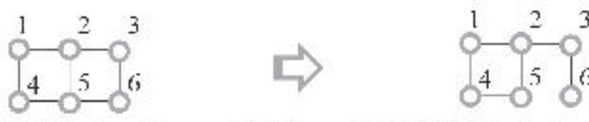
Hệ thống ban đầu      Hệ thống sau khi liên kết 56 bị gián đoạn
