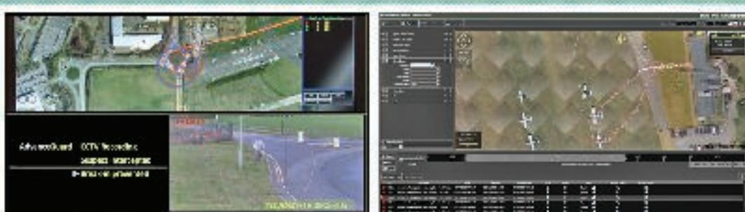
Hệ thống AdvanceGuard lắp bản đồ khu vực, truy vết đối tượng xâm nhập, tự động điều hướng camera
